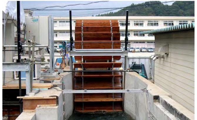
**ROUE DE MOULIN MODERNE OFFRANT UNE PUISSANCE DE 27 KW.**
